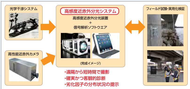
遠方から短時間かつ安価にコンクリート劣化成分の分析ができる近赤外イメージング技術
