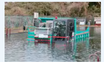
半水中環境での無人化施工のための運搬ロボット
