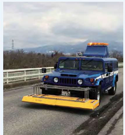
車載型高速スキャンレーダーによる床版内部の診断
