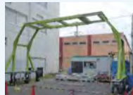
交通を阻害しない変形フレーム型点検システム
